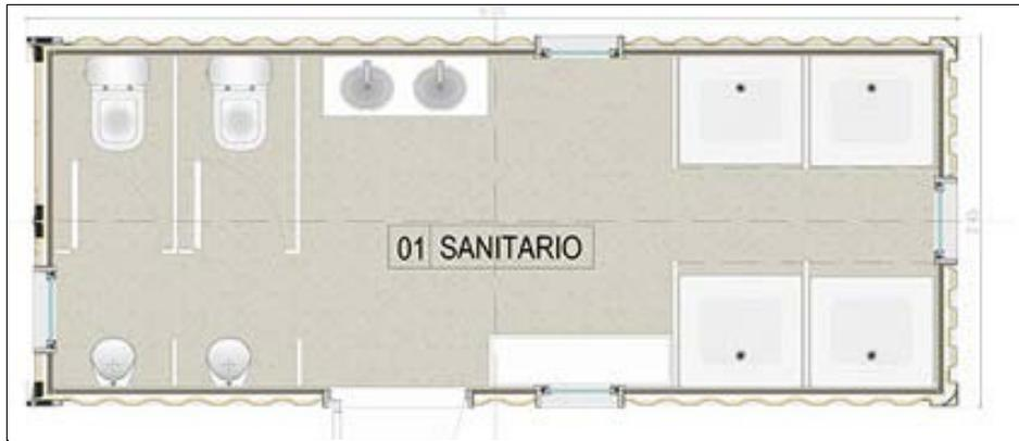
Figura 24: Esquema de módulo de baño
