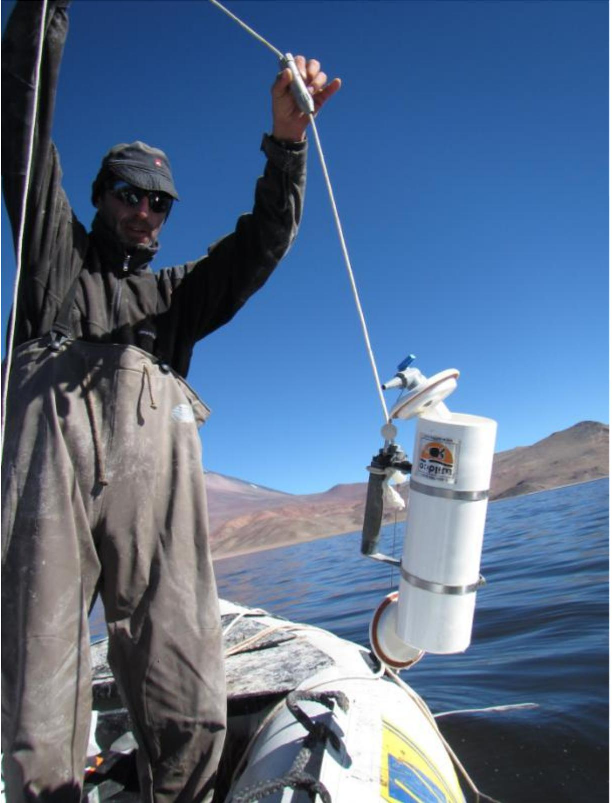
Figura 24 Toma de muestras en la laguna con muestreador de agua sumergible
