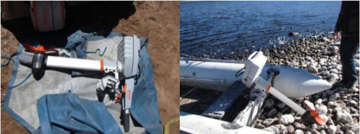
Figura 23 Motor eléctrico instalado en el gomón utilizado para realizar muestras en la laguna Tres Quebradas
